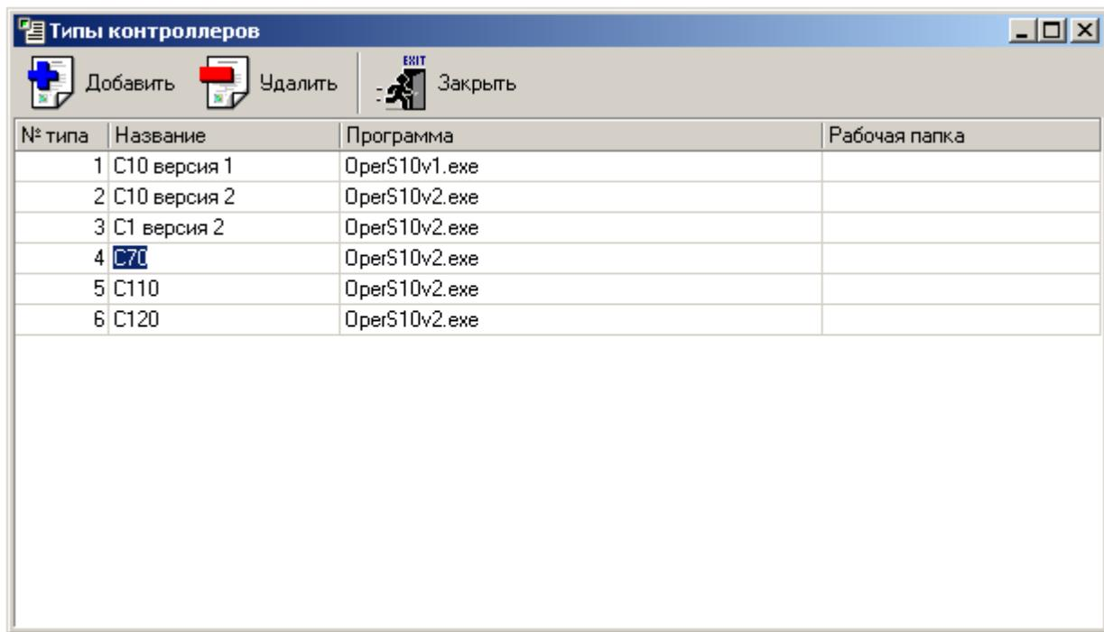
Подменю «Типы контроллеров» предназначено для добавления и удаления типов (версий) контроллеров. При добавлении нового типа контроллера необходимо прописать его название, задать программу, которая будет работать с данным типом контроллеров и рабочую папку, в которой будут храниться файлы настроек.
