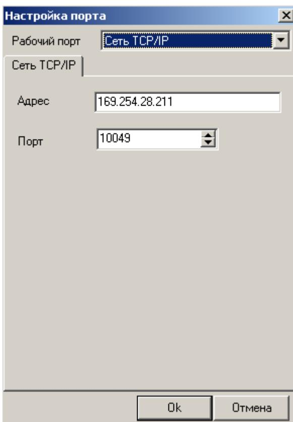
При помощи вкладки «Сеть TCP/IP» осуществляется доступ к контроллеру через Ethernet соединение по протоколу TCP/IP. Для этого необходимо указать IP-адрес контроллера и TCP-порт. Выставленное значение порта должно совпадать со значением порта в Ethernet-модуле контроллера.
