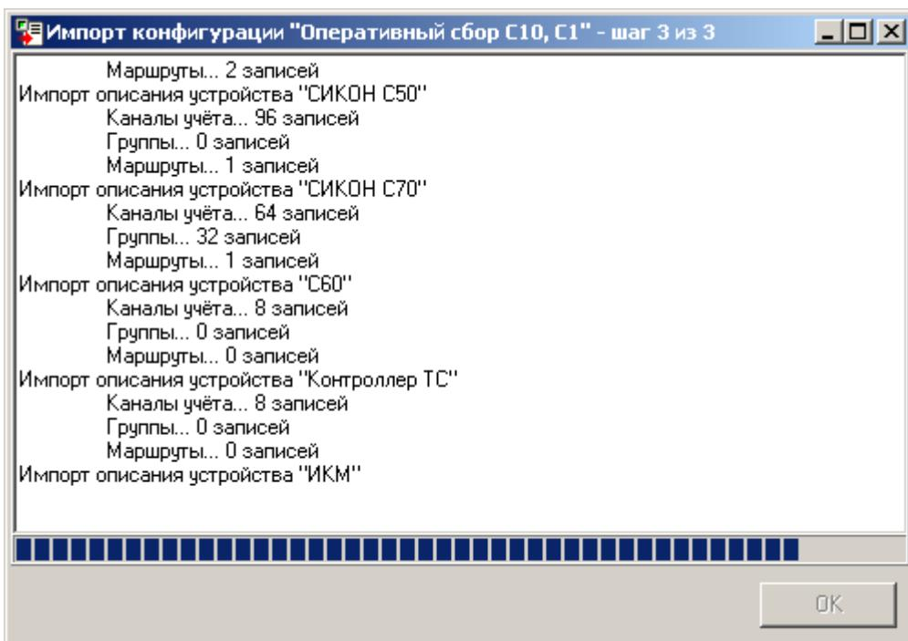
На третьем этапе производится собственно импорт конфигурации. В основном поле диалогового окна третьего шага ведется журнал действий, которые производятся при импорте. Из журнала пользователь может выяснить справочную информацию. Внизу окна расположена строка, отражающая процесс выполнения импорта. После того как импорт завершен, в журнале появляется соответствующая запись. Для закрытия окна и завершения процесса импорта необходимо кликнуть кнопку «OK»
