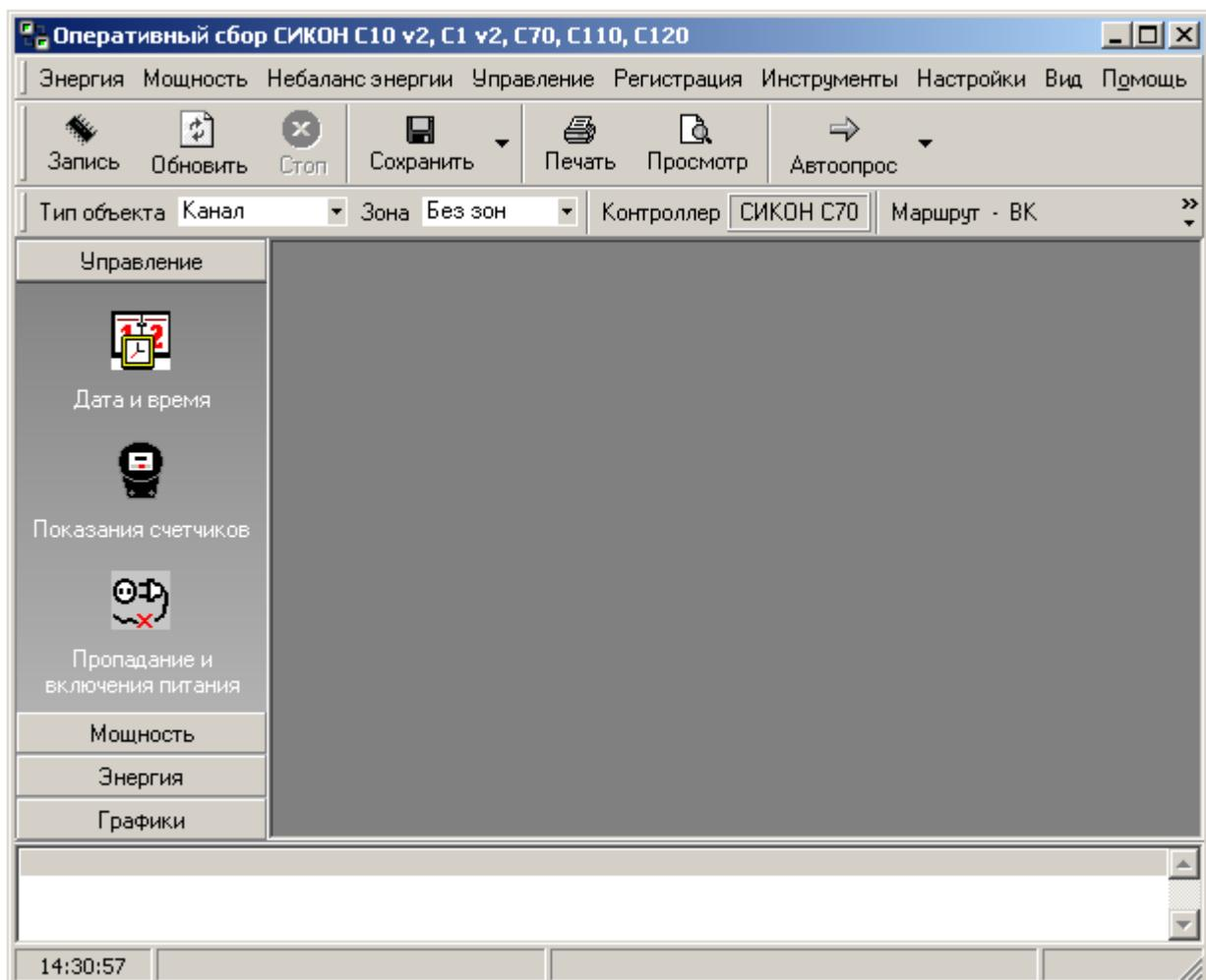
Верхнюю часть окна программы занимает панель инструментов. Под панелью инструментов находится панель объекта. Она определяет, какой объект будет опрашиваться. Здесь можно задать тип объекта (датчик или группа), номер зоны (№1...№12), выбрать станцию, маршрут и сетевой номер контроллера.
