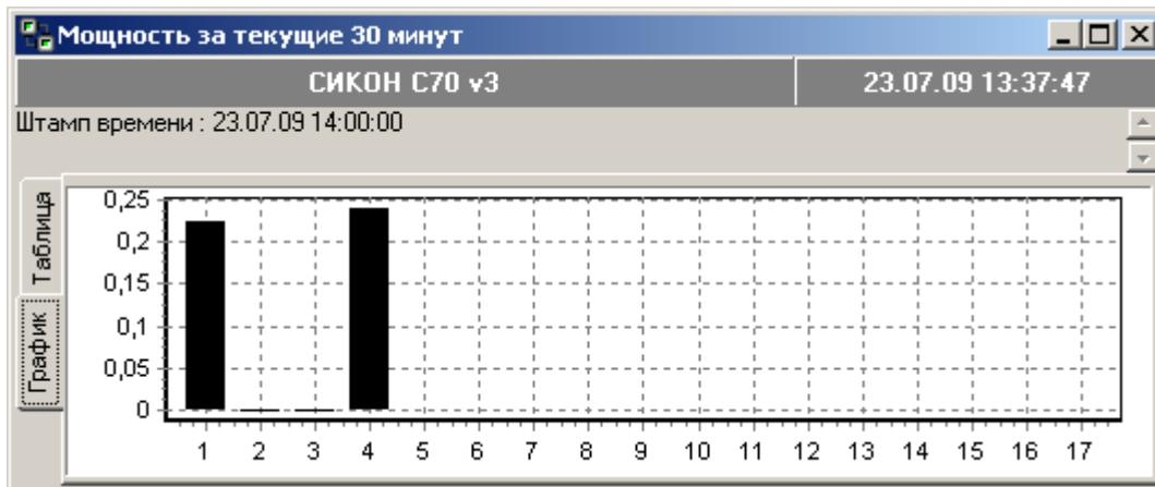
Для выбора режима отображения графиков мощности (графический или текстовый) служат закладки, расположенная в левой части окна.
