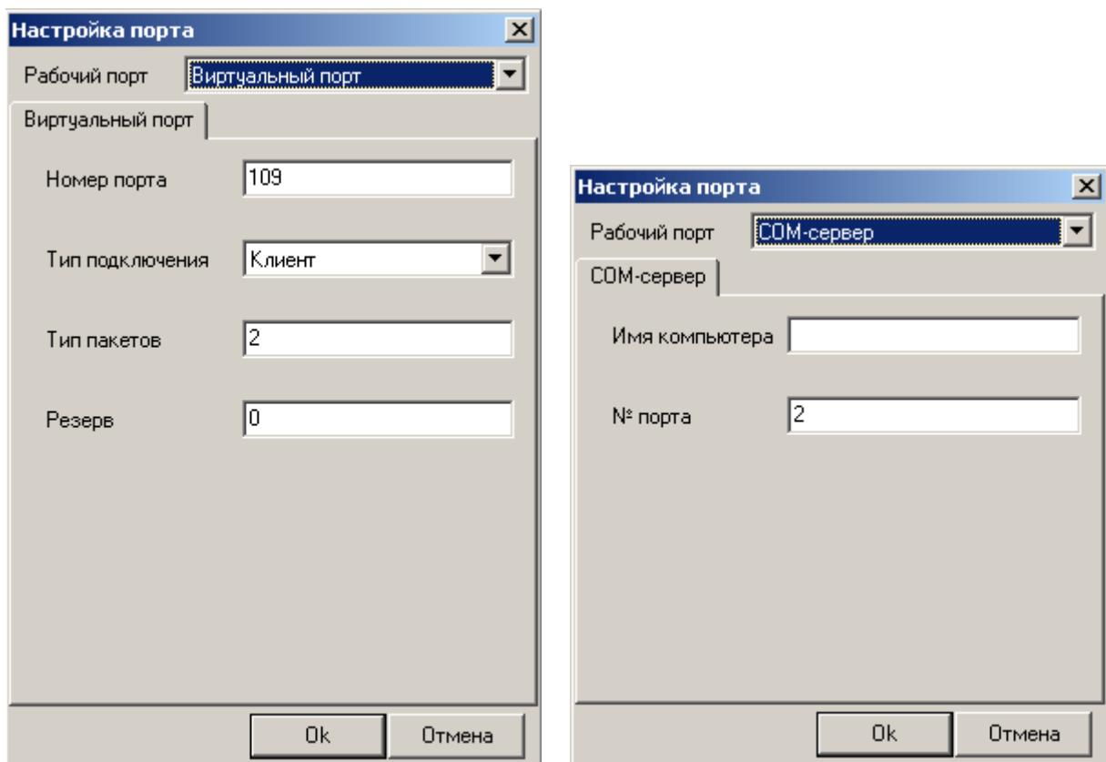
Вкладка “Виртуальный порт” предназначена для стыковки с ПО ИВК «ИКМ-Пирамида». При выборе этой вкладки открывается окно, в котором необходимо задать тип подключения (клиент или сервер), номер порта, прописанного в ПО ИВК «ИКМ-Пирамида».
