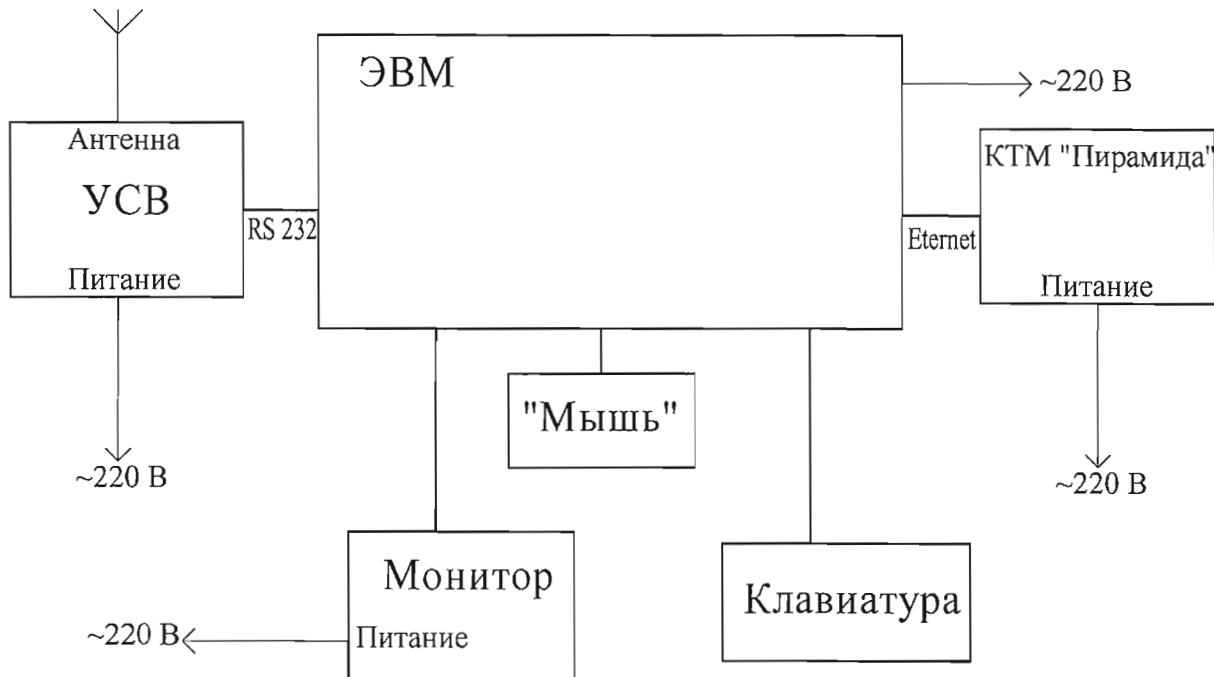
Рисунок 8.4 – Функциональная схема поверки КТМ «Пирамида».
