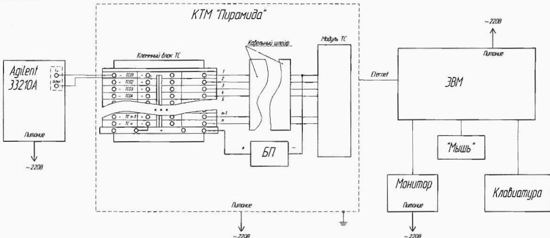
Рисунок 8.6 – Функциональная схема поверки сигналов ТС.
