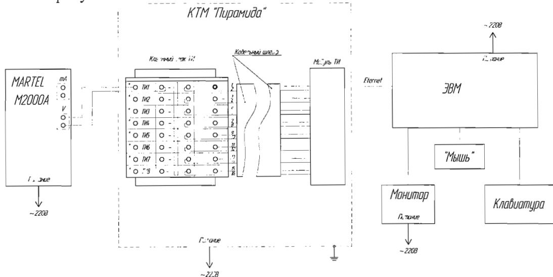
Рисунок 8.3 – Функциональная схема поверки измерения напряжения постоянного тока.
