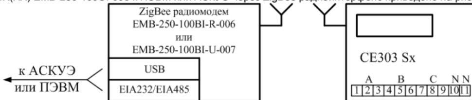
Рисунок 3.8 - Схема подключения счетчика
