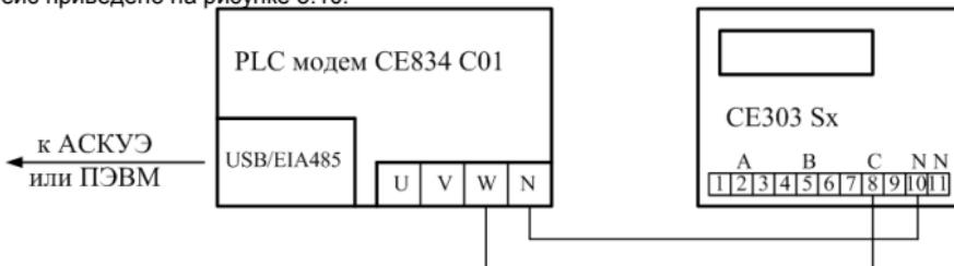
Рисунок 3.10 – Схема подключения счетчика
