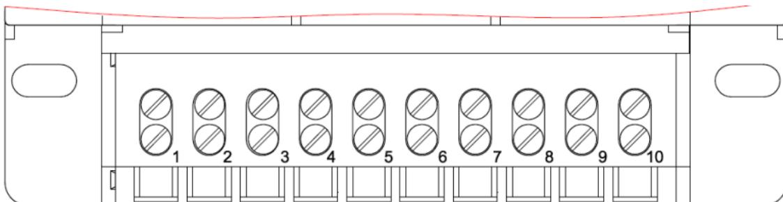
г) - обозначение контактов зажимов счетчика СЕ303 S31 5Х3
