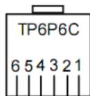
б) обозначение контактов ответной части разъема "19" ТР6Р6С
