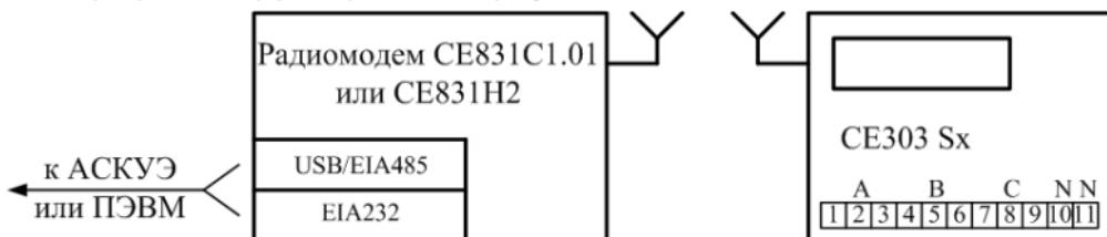
Рисунок 3.7 – Схема подключения счетчика
