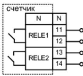
в) CE303 S31 для исполнений со встроенным GSM-модулем
