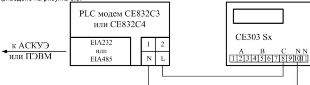
Рисунок 3.9 – Схема подключения счетчика
