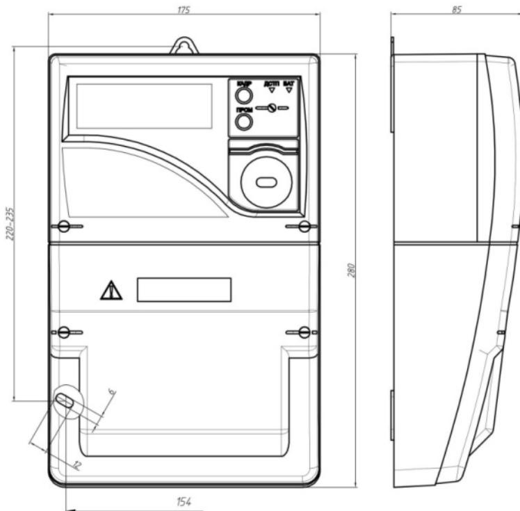
Общий вид счетчика СЕ303 R33 (с укороченной клеммной крышкой)
