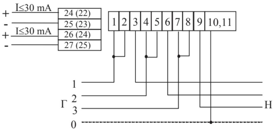
**Внимание!** Перемычки между контактами 1 и 2, 4 и 5, 7 и 8 расположены на токовводной колодке счетчика в виде передвижных планок. Перед подключением счетчика убедиться в том, что перемычки находятся в замкнутом состоянии.
