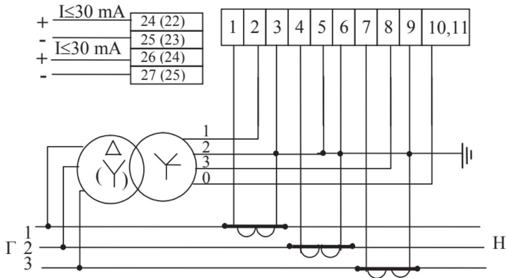
Схема включения счетчиков СЕ 302 S33 503
