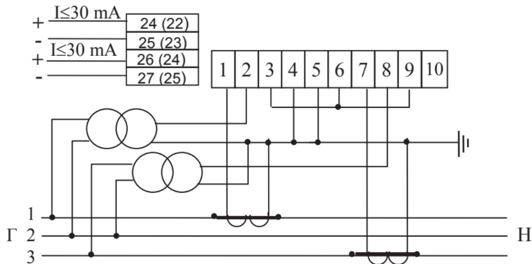
Схема включения счетчиков СЕ 302 S33 503, СЕ 302 S33 543
