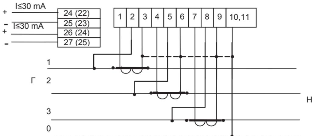
Схема включения счетчиков СЕ 302 S33 745; СЕ 302 S33 746;
