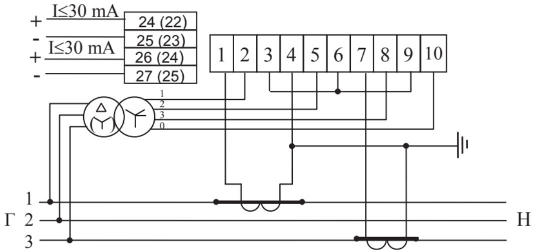
**Внимание!** Заземление цепей напряжения производить согласно схеме подключения трансформатора напряжения на объекте.
