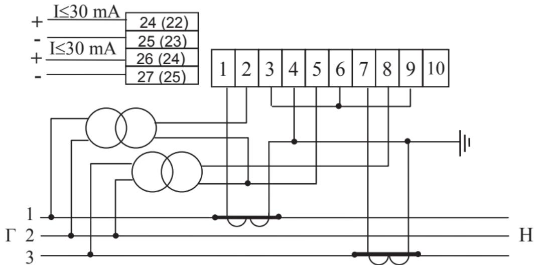
**Внимание!** Заземление цепей напряжения производить согласно схеме подключения трансформатора напряжения на объекте.
