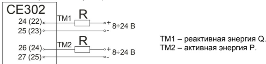
Рисунок 2- Схема включения испытательного выходного устройства
