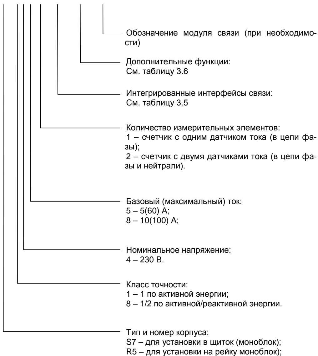
Рисунок 3.1 – Структура условного обозначения счетчика
