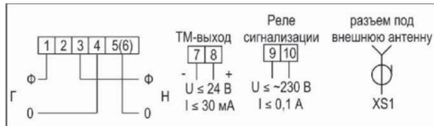
Рисунок В.6 – Схема включения счетчиков СЕ 102 тип корпуса S7,
