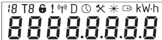
Рисунок 7.1 – Общий вид ЖКИ счетчика в режиме теста
