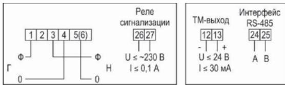
Рисунок В.15 – Схема включения счетчиков СЕ 102 тип корпуса R8,
