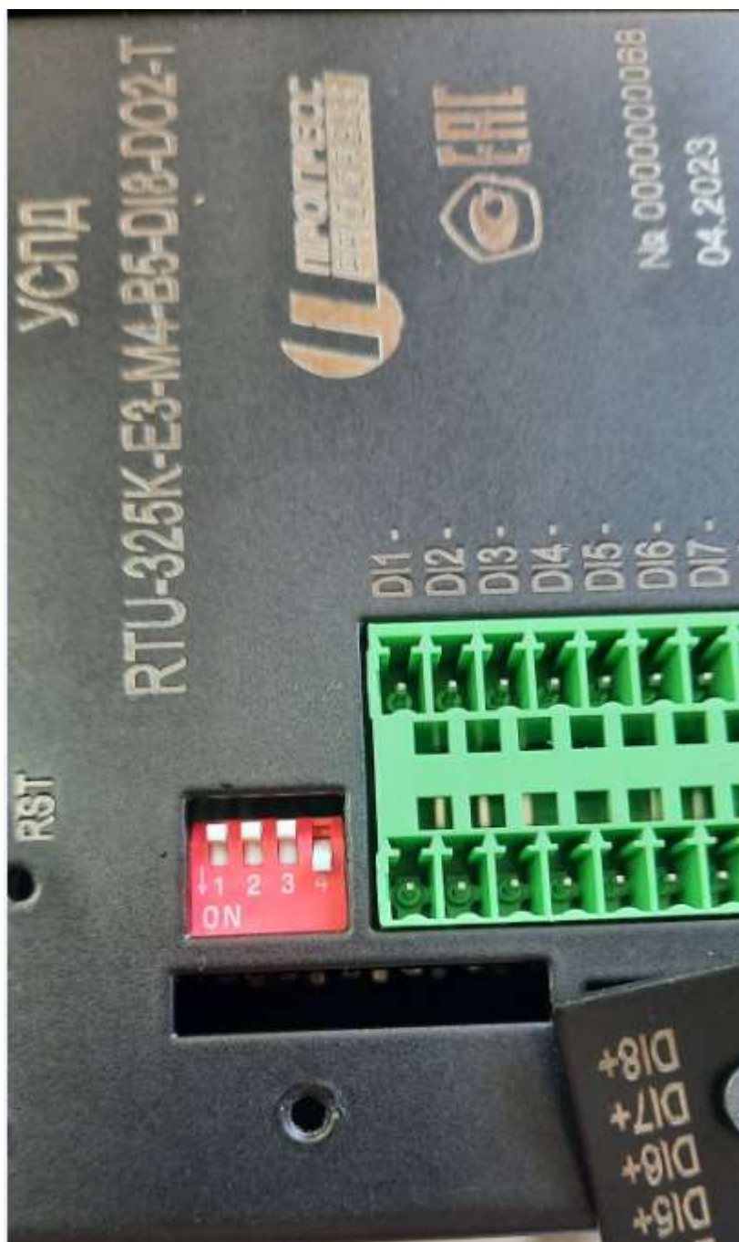
Рис.1.10. Под крышкой S1 расположены 4 переключателя.
