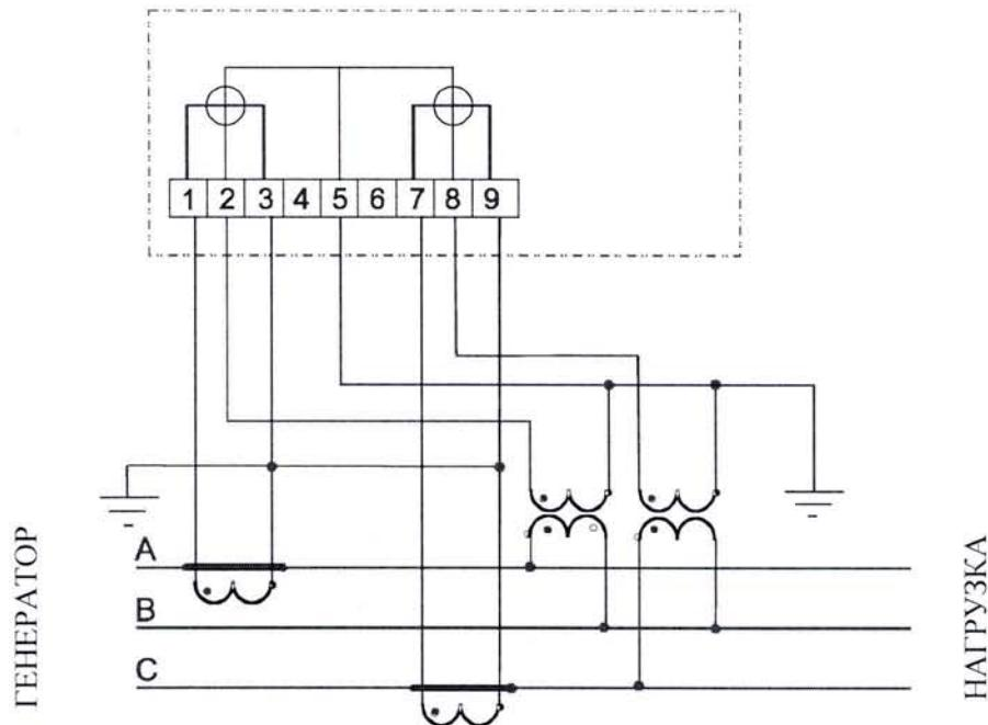
Рисунок А.6 - Схема подключения двухэлементного счетчика
