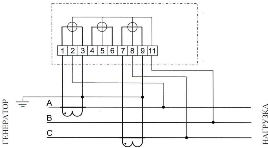
Рисунок А.12 - Схема подключения трехэлементного счетчика в трехпроводную сеть с изолированной нейтралью
