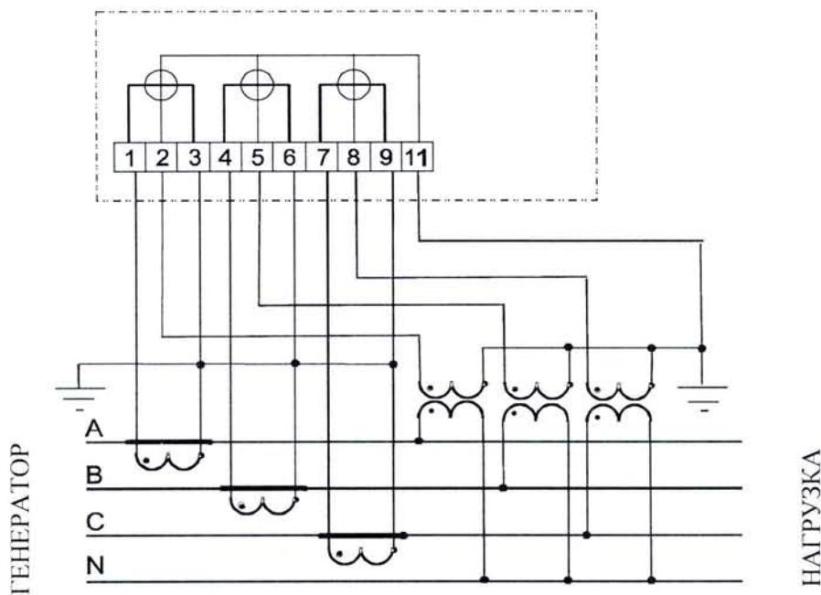
Рисунок А.4 - Схема подключения трехэлементного счетчика
