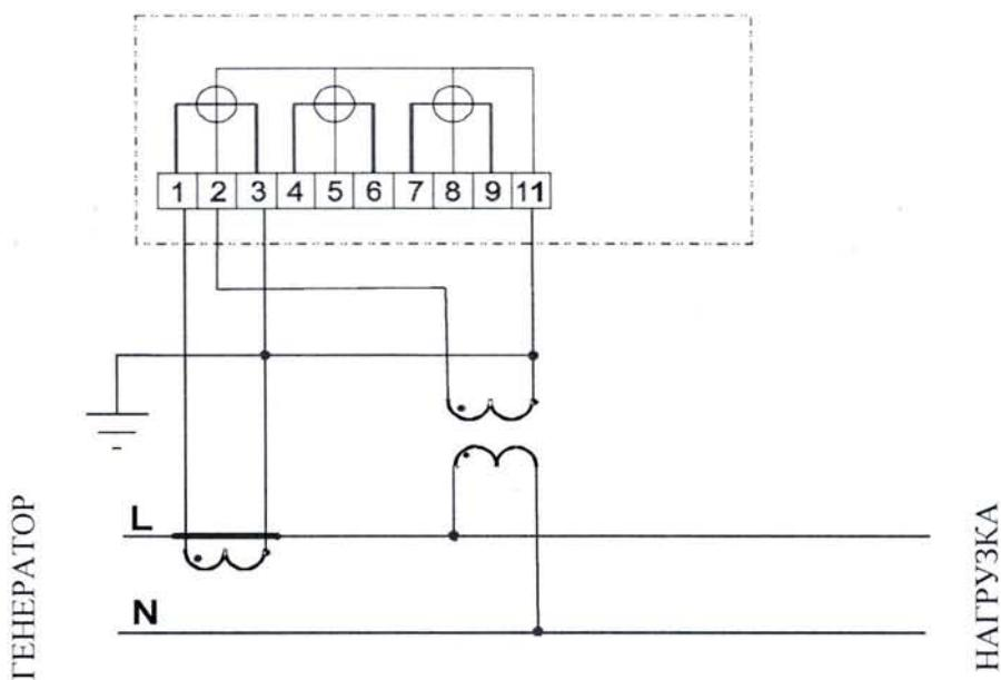
Рисунок А.13 – Схема подключения трехэлементного счетчика
