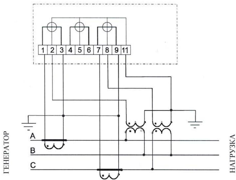
Рисунок А.7 - Схема подключения трехэлементного счетчика в трехпроводную сеть с двумя трансформаторами напряжения
