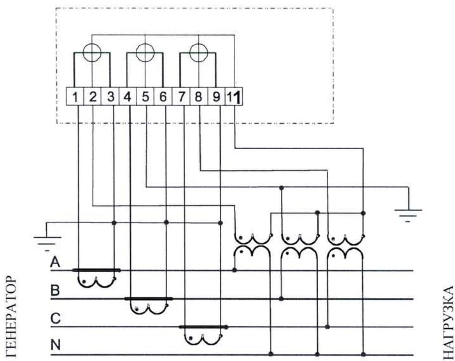
Рисунок А.5 - Схема подключения трехэлементного счетчика
