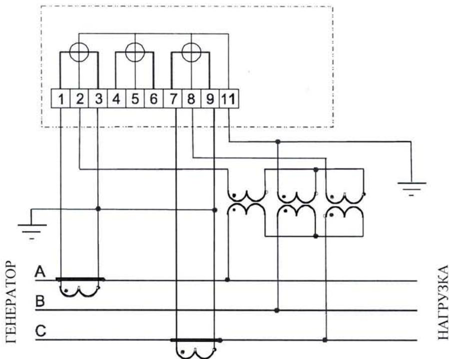
Рисунок А.9 - Схема подключения трехэлементного счетчика
