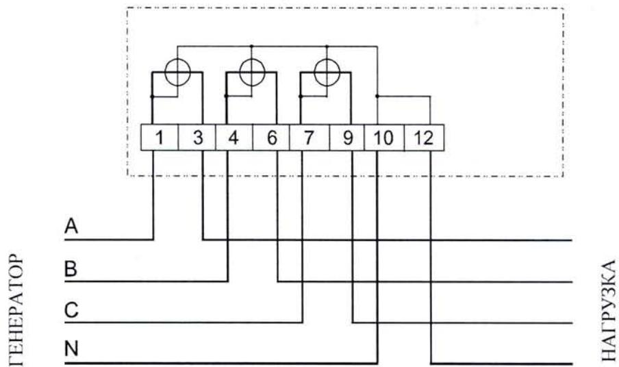
Рисунок А.1 - Схема подключения счетчика непосредственного включения
