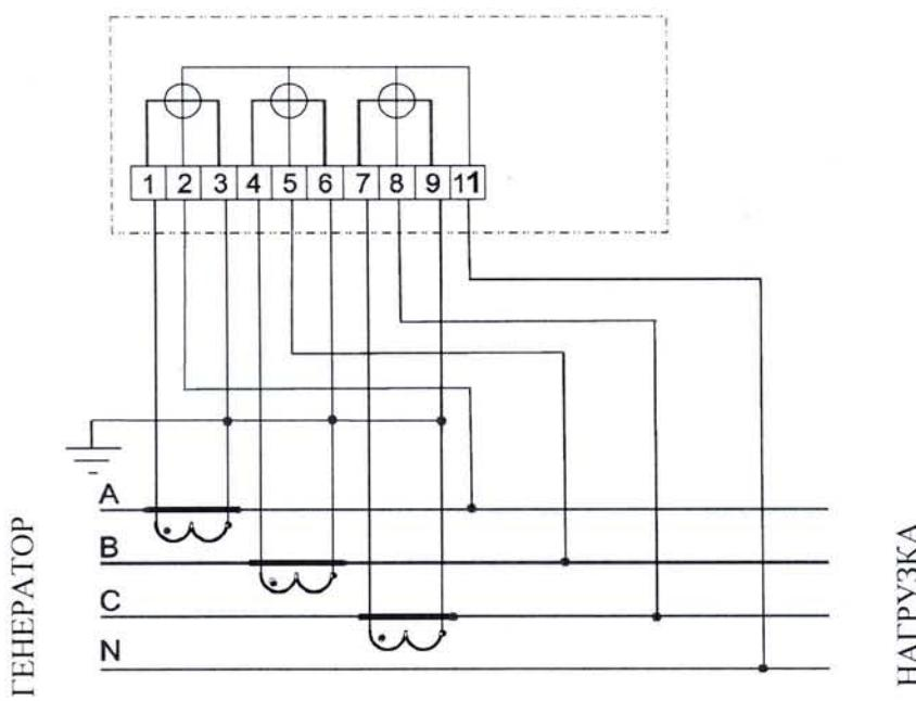
Рисунок А.3 - Схема подключения трехэлементного счетчика
