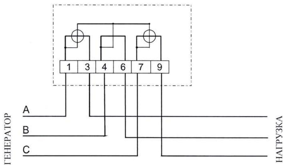
Рисунок А.2 - Схема подключения двухэлементного счетчика непосредственного
