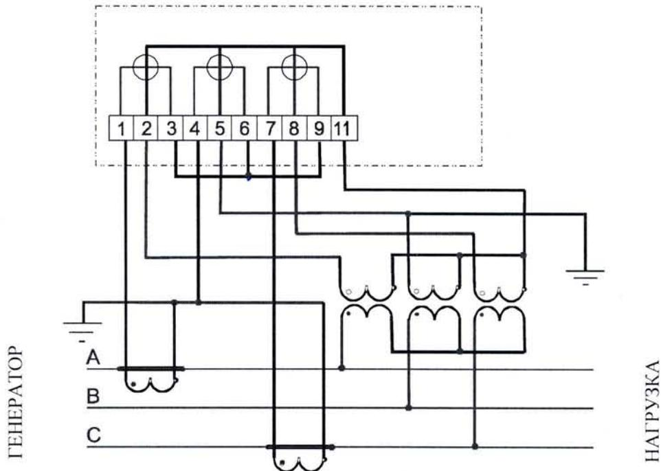
Рисунок А.10 - Схема подключения трехэлементного счетчика
