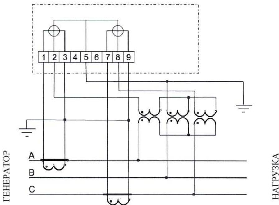
Рисунок А.8 - Схема подключения двухэлементного счетчика в трехпроводную сеть с тремя трансформаторами напряжения и заземленной фазой В
