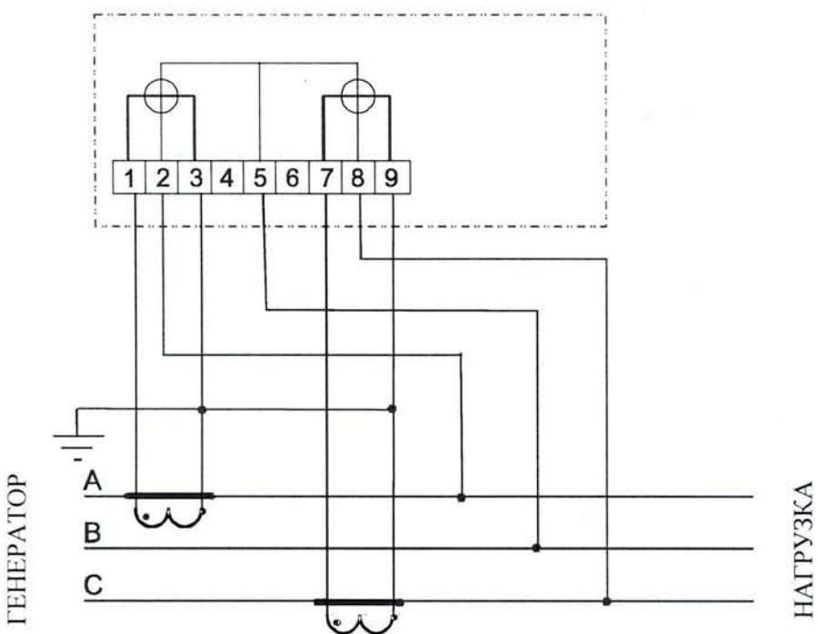
Рисунок А.11 - Схема подключения двухэлементного счетчика в трехпроводную сеть с изолированной нейтралью
