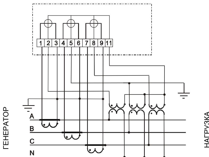
Рисунок Б.2 – Схема включения трехэлементного счетчика
