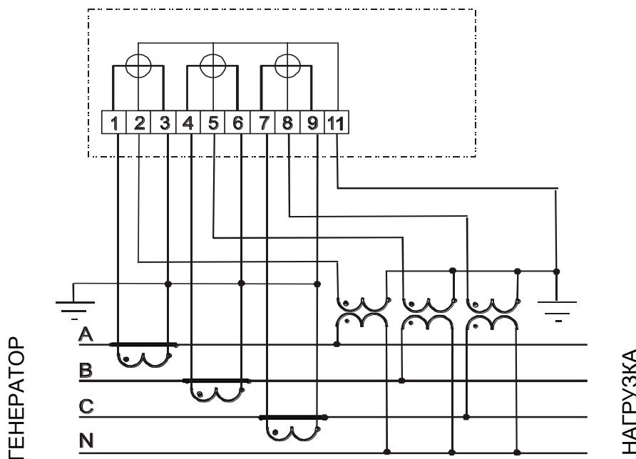
Рисунок Б.1 – Схема включения трехэлементного счетчика
