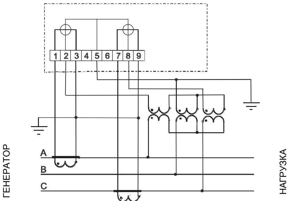
Рисунок Б.7 – Схема включения двухэлементного счетчика
