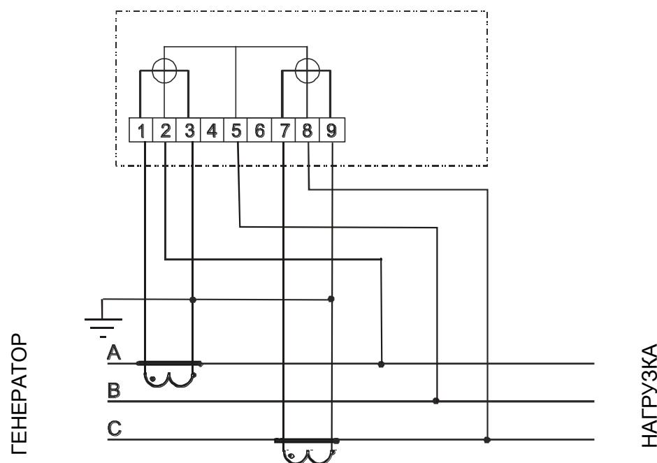
Рисунок Б.8 – Схема включения двухэлементного счетчика
