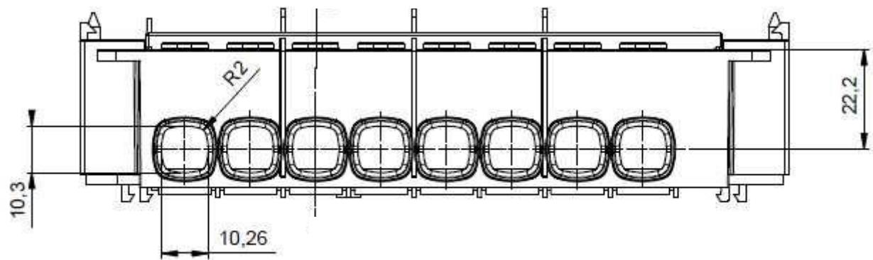
Рисунок А.3 – Зажимная плата счетчика непосредственного включения
