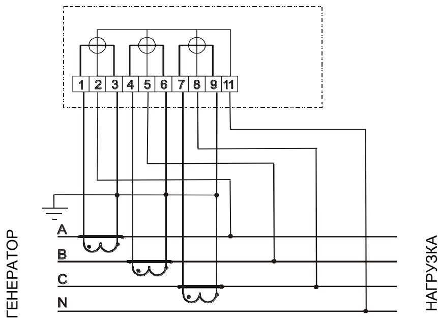
Рисунок Б.3 – Схема включения трехэлементного счетчика
