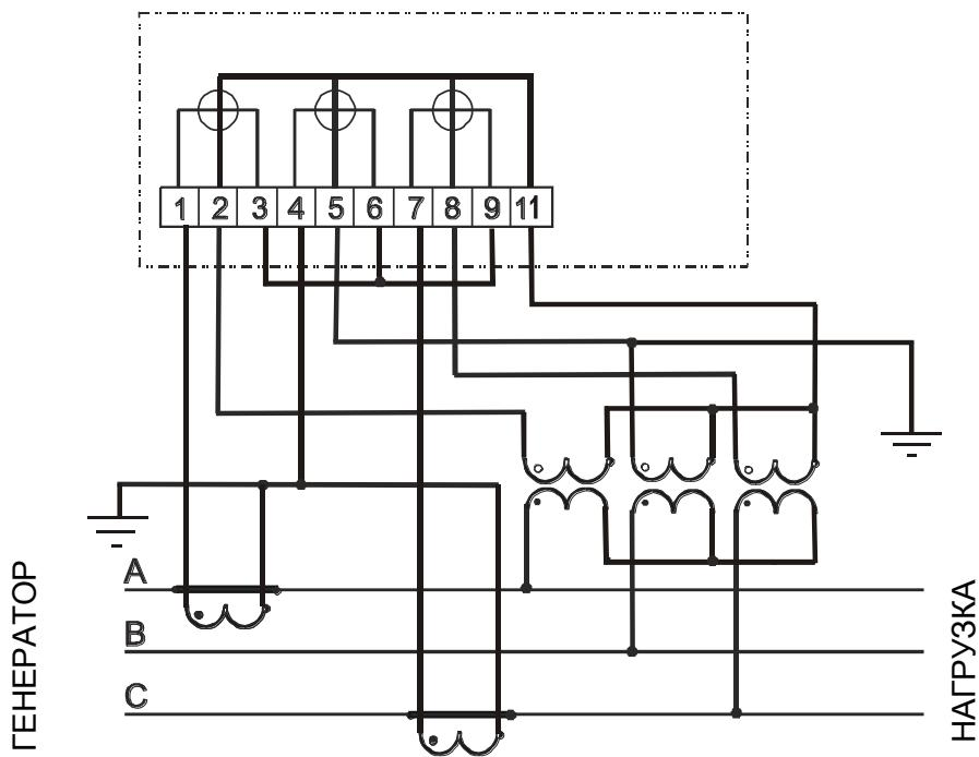
Рисунок Б.4 - Схема включения трехэлементного счетчика
