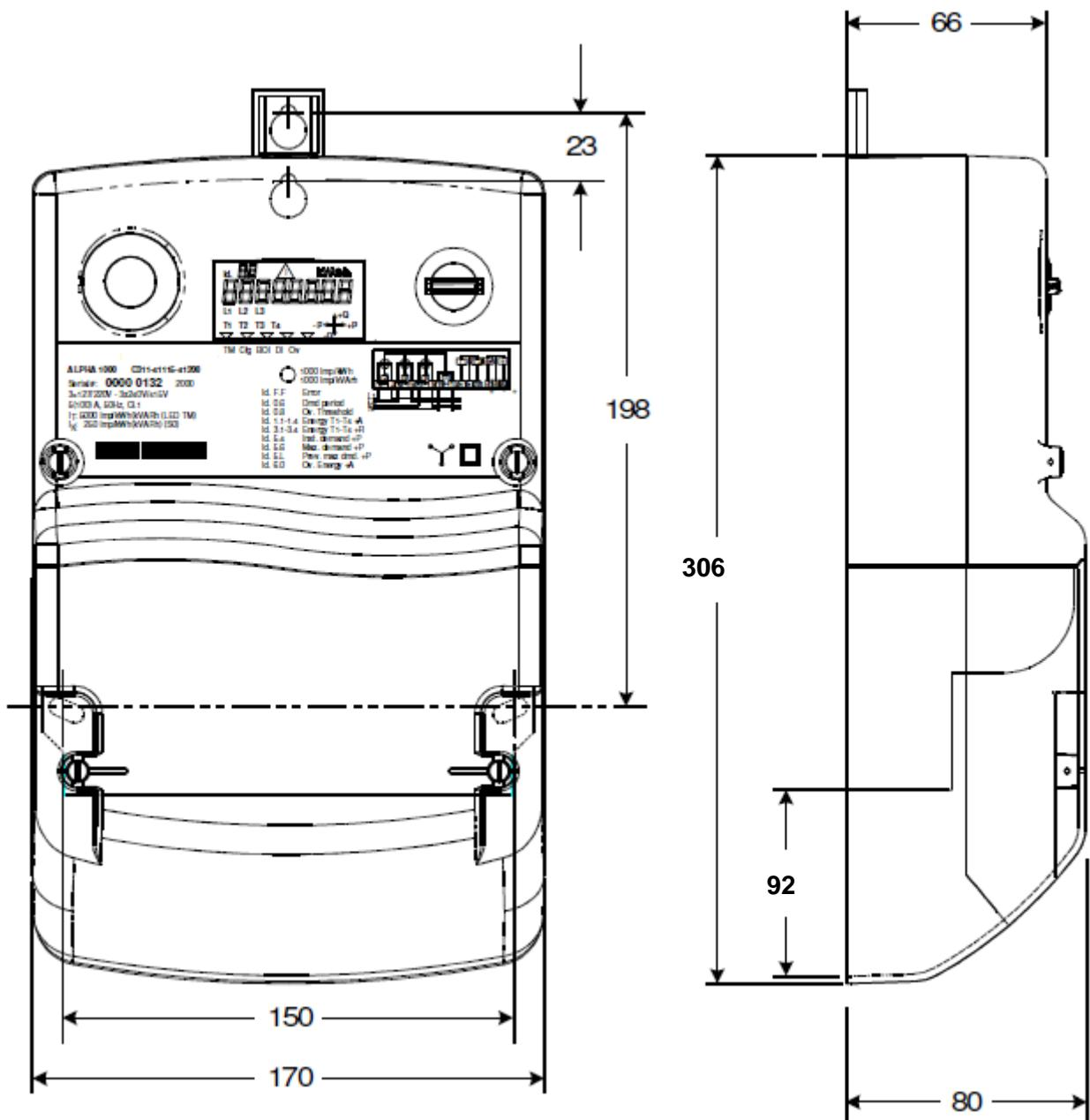
Рисунок А.2 – Габаритные и установочные размеры счетчика с размыкающим реле
