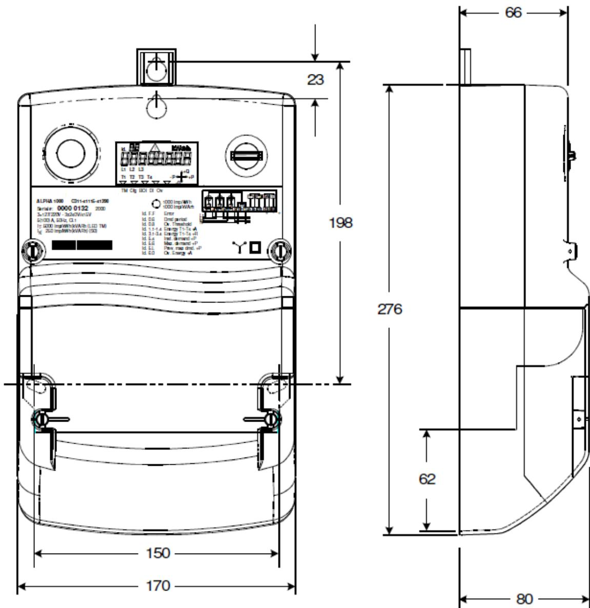
Рисунок А.1 – Габаритные и установочные размеры счетчика
