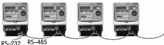
Цифровые интерфейсы позволяют подключить до 32 счетчиков на общую шину
