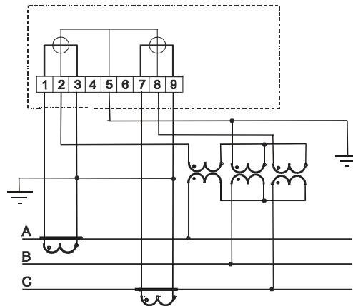
Рисунок Б.5 – Схема включения двухэлементного счетчика
