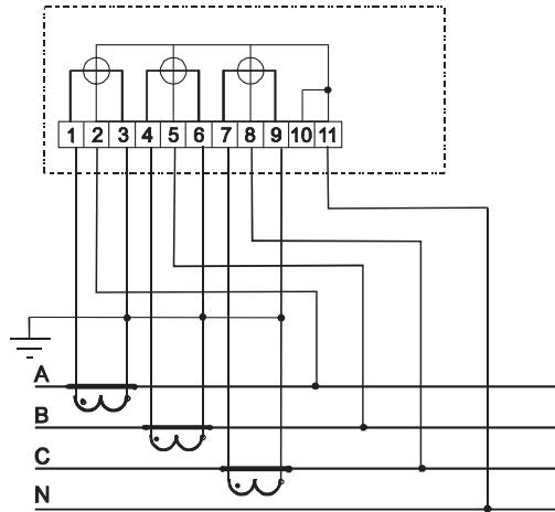
Рисунок Б.3 – Схема включения трехэлементного счетчика
