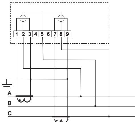
Рисунок Б.6 – Схема включения двухэлементного счетчика
