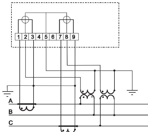
Рисунок Б.4 – Схема включения двухэлементного счетчика
