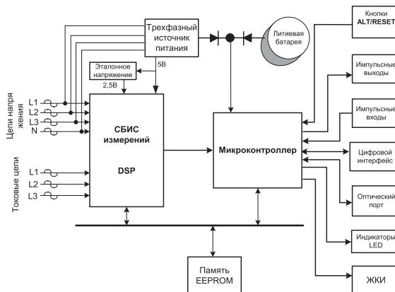
Рисунок 3 – Структурная схема счетчика Альфа А1700
