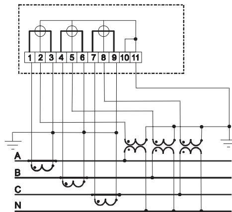
Рисунок Б.1 – Схема включения трехэлементного счетчика
