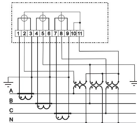
Рисунок Б.2 – Схема включения трехэлементного счетчика
