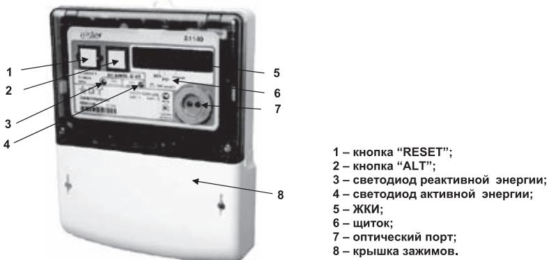
Рисунок 1 - Внешний вид счетчика Альфа А1140
