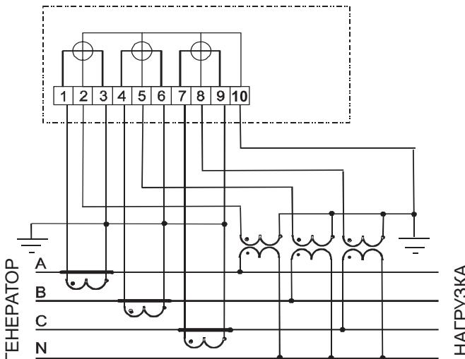
Рисунок Б.6 - Схема включения трехэлементного счетчика
