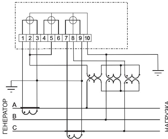
Рисунок Б.9 - Схема включения трехэлементного счетчика
