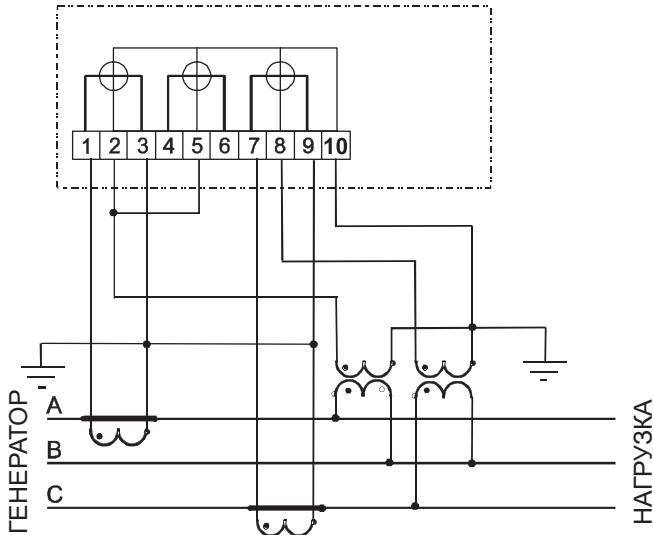
Рисунок Б.8 - Схема включения трехэлементного счетчика
