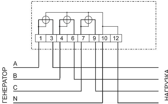
Рисунок Б.1 - Схема подключения счетчика непосредственного включения в четырехпроводную сеть напряжением 0,4 кВ
