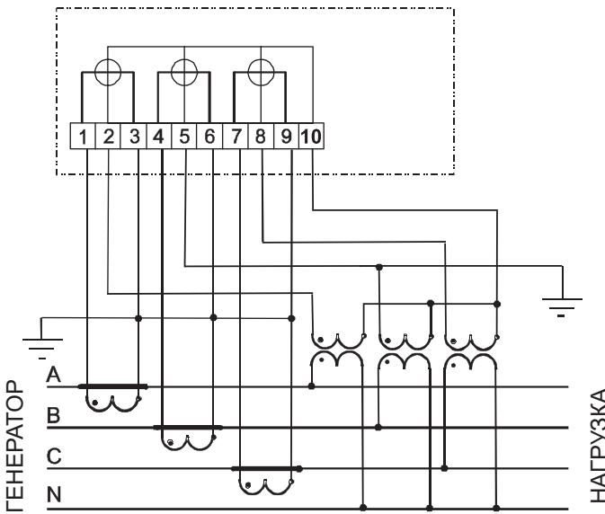
Рисунок Б.7 - Схема включения трехэлементного счетчика
