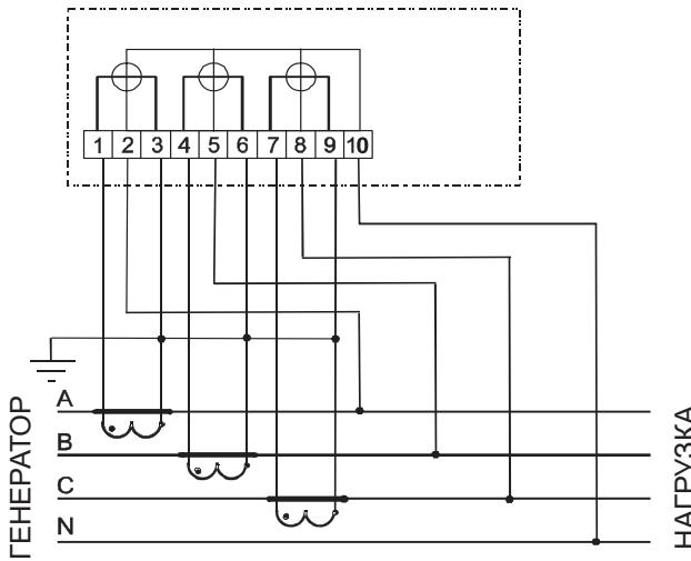
Рисунок Б.5 - Схема включения трехэлементного счетчика
