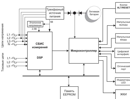
Рисунок 2 – Структурная схема счетчика Альфа А1140
