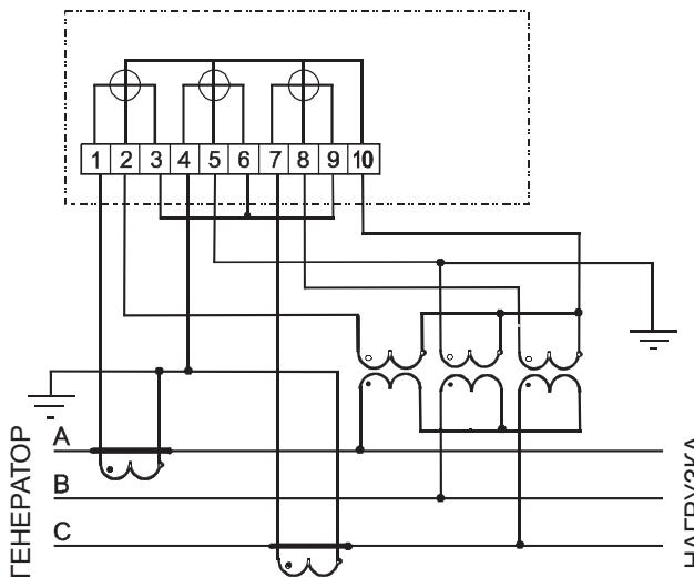
Рисунок Б.10 - Схема включения трехэлементного счетчика
