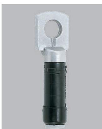
Изолированные наконечники представляют собой полую несквозную трубку, выполненную из алюминия, которая помещена в корпус из стойкого к механическим и климатическим воздействиям диэлектрика, соединенную методом сварки трением с контактной пластиной, выполненной из алюминия (CPTA) или меди (CPTAU). Эластичная заглушка обеспечивает герметичность соединения с проводом. Трубка наконечника заполнена контактным смазочным
