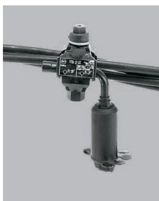
Комплект состоит из прокалывающего зажима (TTD) и стандартного модуля ответвления со штыревым замком (FCC1). Обеспечивается возможность установки комплекта на линию под напряжением без снятия изоляции с провода. Блок ответвления оснащен стандартным модулем со штыревым замком с защитным кожухом. Отдельно комплектуется устройством для короткого замыкания и устройством для заземления.
