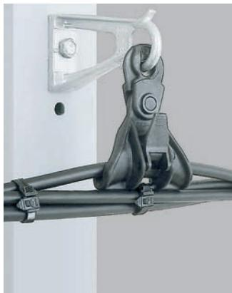
Комплект используется для крепления провода СИП-2 на промежуточных и угловых опорах в пределах разрешенных значений углов поворота линии. Комплект представляет собой изделие в сборе, составными частями которого являются кронштейн CS, выполненный из алюминиевого сплава, и поддерживающий зажим PSQ 54 либо PSQ 70 с подвижным звеном. Диаметр возможного крепления проводов 8,5-17 мм.
