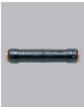
Гильзы MJPT... – применяются для герметичного соединения фазных проводов основной магистрали СИП. Соединительный элемент выполнен из алюминия. Гильзы этой серии выдерживают растягивающее усилие не менее 60% от МРН провода. Гильзы MJPT...N – применяются для герметичного соединения нулевого несущего провода основной магистрали СИП. Соединительный элемент выполнен у таких гильз из алюминиевого сплава. Гильзы MJPT...N выдерживают
