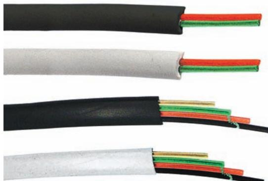
Кабели Netko 2с и 4с предназначены для создания линий и каналов класса С в соответствии с ISO/IEC 11801. Кабель состоит из 2(4) изолированных проводников, размещенных в общей внешней оболочке. Тип жилы – многожильная, из медной проволоки. Кабели предназначены для стационарной прокладки внутри зданий, сооружений и эксплуатации в структурированных кабельных системах, для передачи данных и телефонных сигналов на частотах до 16 МГц.
