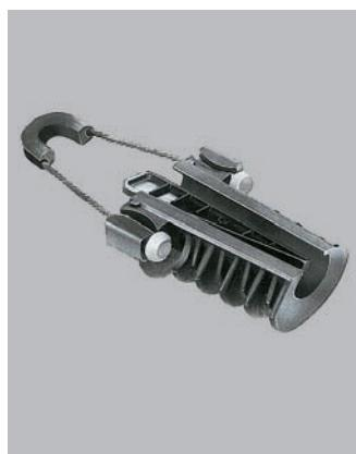
Используются для анкерного крепления СИП с 2-мя или 4-мя проводами одинакового сечения. Состоят из открытого корпуса из термопластика, обладающего высокой степенью устойчивости к механическим и погодно-климатическим воздействиям, клина и крепления (гибкий тросик из нержавеющей стали с седлом). Использованные материалы защищены от воздействия природного ультрафиолетового излучения. Диэлектрический корпус анкерных зажимов имеет
