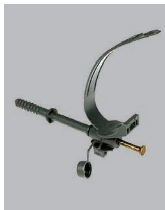
Фасадные крепления применяются для монтажа пучка СИП диаметром 20-50 мм на стенах и фасадах зданий. Устойчивы к механическим и погодно-климатическим воздействиям. Снабжены колпачком для дополнительной защиты шляпки гвоздя от коррозии; Фасадные крепления обеспечивают фиксированное расстояние от СИП до фасада: BRPF 1-10 мм, BRPF 6-60 мм, BRTF 10-100 мм.
