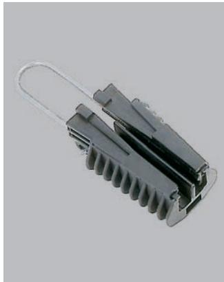
Применяются для выполнения абонентских ответвлений 2-мя или 4-мя проводами одинакового сечения. Состоит из петли, выполненной из нержавеющей стали, клиньев и корпуса, изготовленных из композитного диэлектрика, стойкого к механическим нагрузкам и погодно-климатическим воздействиям.
