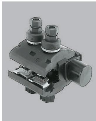
Прокалывающие зажимы предназначены для выполнения электрических соединений неизолированных алюминиевых проводов магистральной линии с изолированными алюминиевыми или медными проводами ответвлений. Обеспечивают герметичное подключение без необходимости снятия изоляции с провода. Необходимое усилие прокалывания изоляции обеспечивается при любых температурах монтажа за
