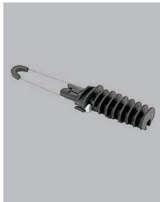
Используются для анкерного крепления изолированного нулевого несущего провода. Состоят из открытого корпуса из термопластика, обладающего высокой степенью устойчивости к механическим и погодно-климатическим воздействиям, клина и крепления (гибкий тросик из нержавеющей стали с седлом). Использованные материалы защищены от воздействия природного ультрафиолетового излучения. Диэлектрический корпус анкерных зажимов имеет
