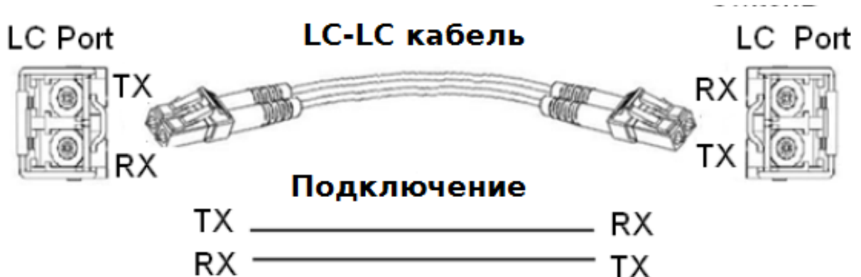
Рис. Подключение оптического кабеля
