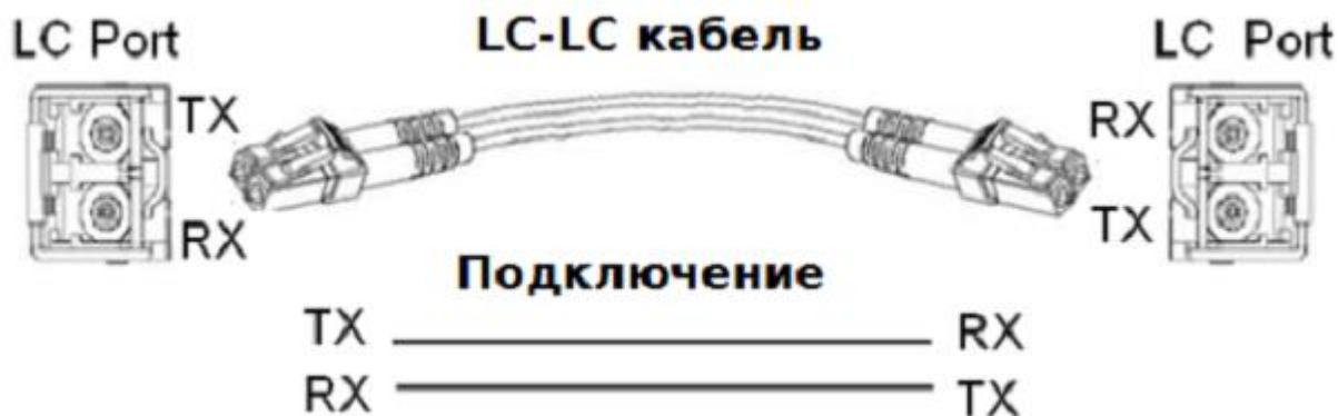
Рис. Подключение оптического кабеля
