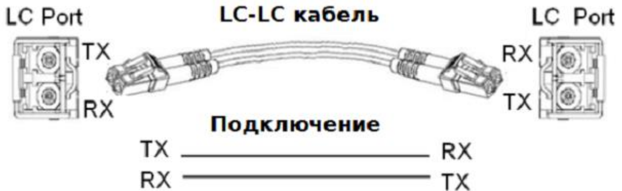
Рис. Подключение оптического кабеля
