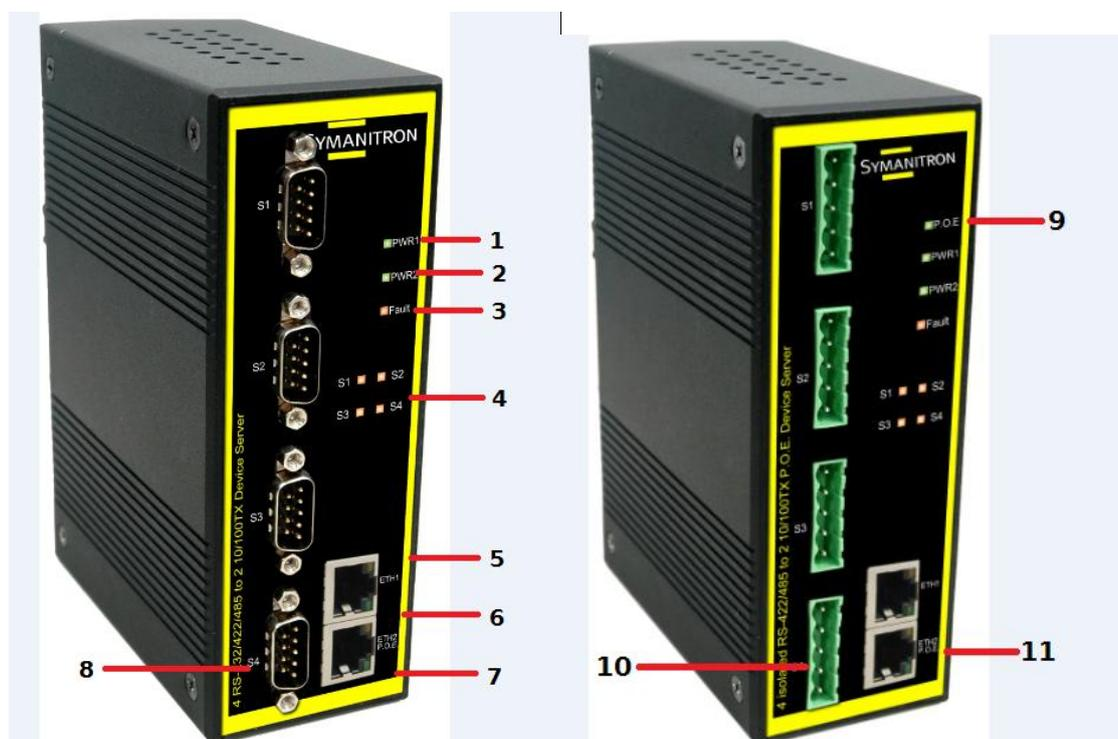
1. Индикатор PWR1 и состояния системы. При подключении PWR1 загорается зеленая лампочка.
