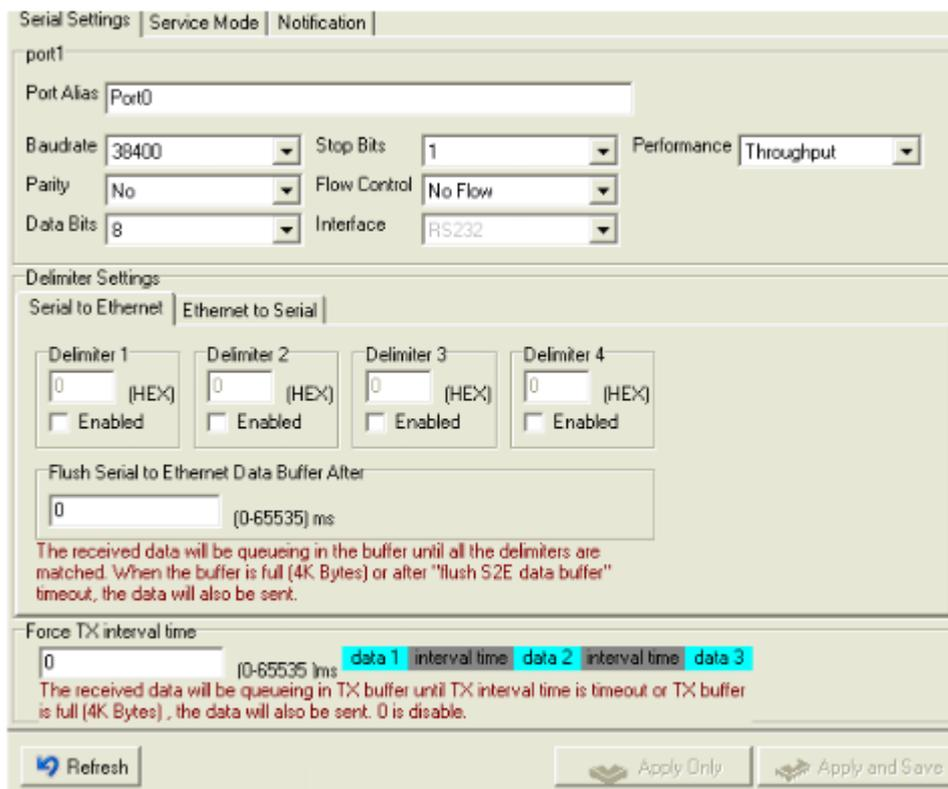
Рис. Настройка последовательных портов
