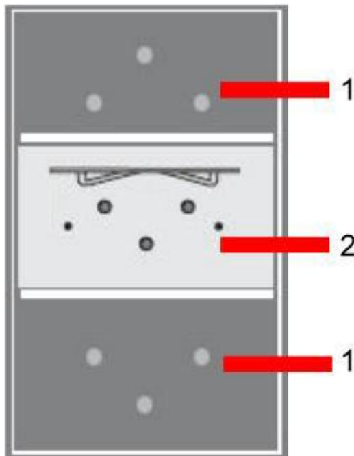
1. Отверстия под шурупы для креплений на стену
