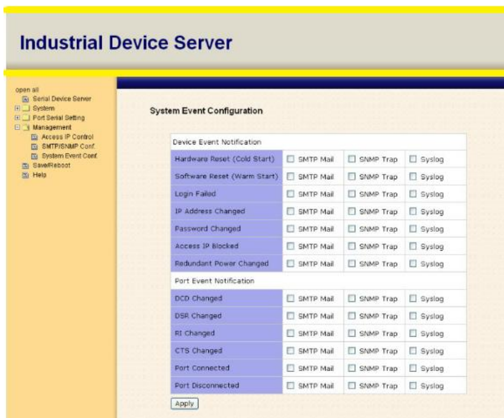
Рис. Настройка SMTP/SNMP
